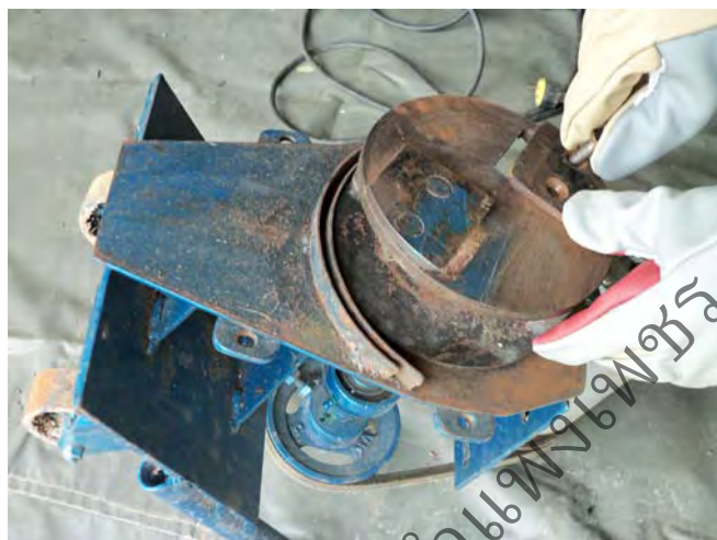
ภาพที่ 25 การติดใบมีดกับฐานรอง
