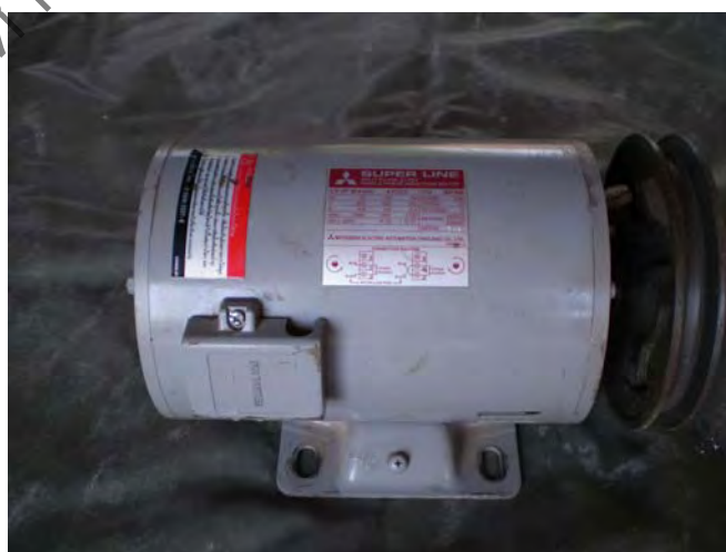
ภาพที่ 22 ขนาดมอเตอร์ ครึ่งแอมป์
