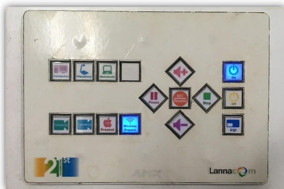
ภาพที่ 277 สถานะไฟแจ้งเตือนสถานะ On บนแผงควบคุม
