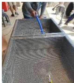
ภาพที่ 185 ตะแกรงรูเล็กและถี่สำหรับวางผักผลไม้ ให้สะเด็ดน้ำก่อนบรรจุถุงเพื่อจำหน่าย
