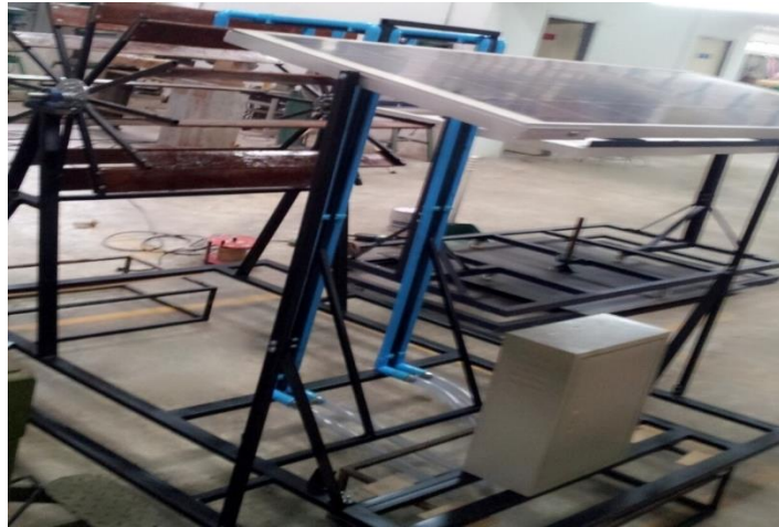
รูปที่ 3.8 ลักษณะการติดตั้งแผงเซลล์แสงอาทิตย์
