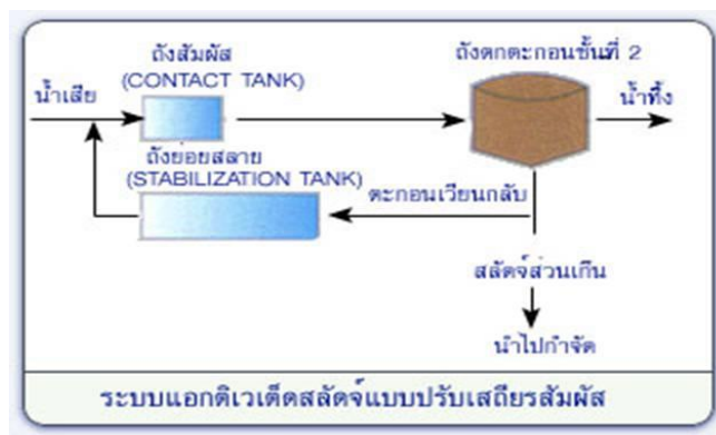
รูปที่ 2.10 ระบบแอกทิเวเตดสลัดจ์แบบปรับเสถียรสัมผัส
