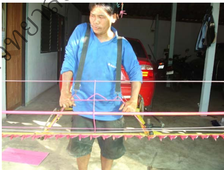
ภาพที่ 37 แสดงเครื่องกำจัดข้าววัชพืชที่ประกอบเสร็จเรียบร้อยแล้ว
