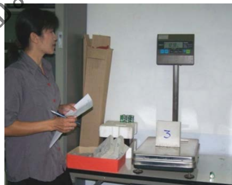
ภาพที่ 17 แสดงลักษณะการชั่งน้ำหนักส่วนผสมสูตรเดิมกับสูตรที่ 1-5
