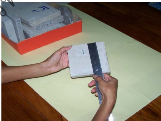
ภาพที่ 13 แสดงลักษณะการวัดความยาวของแท่งส่วนผสมวัสดุ
