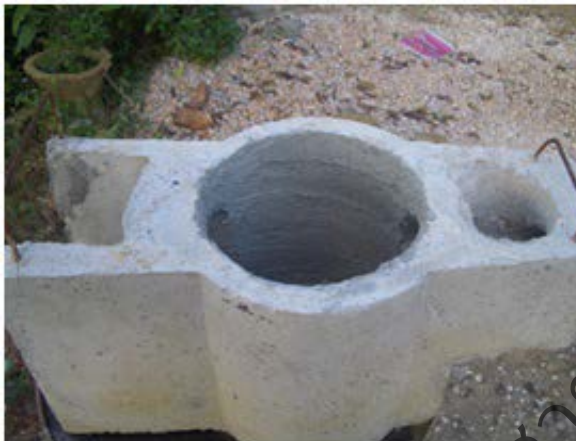
ภาพที่ 22 แสดงลักษณะเตาหุงต้มผลิตจากส่วนผสมที่พัฒนาขึ้น
