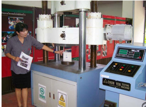
ภาพที่ 16 แสดงการใช้เครื่องวัดหาค่าความแข็งแรง (แบบกด) ของแท่งส่วนผสมวัสดุ
