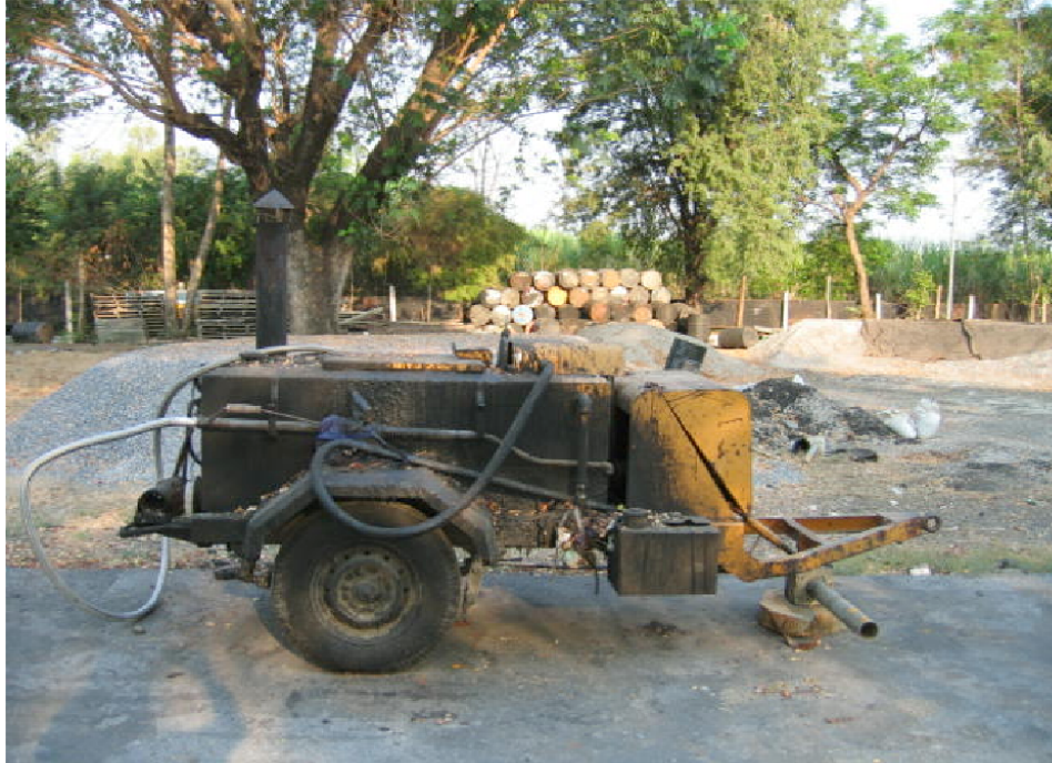
ภาพที่ 28 แสดงลักษณะของเครื่องสเปรย์ยางแอสฟัลท์เครื่องต้นแบบ
