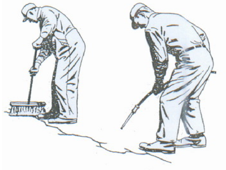
ภาพที่ 20 แสดงการทำทำความสะอาดรอยแตกด้วยไม้กวาดหรือเครื่องอัดลม
