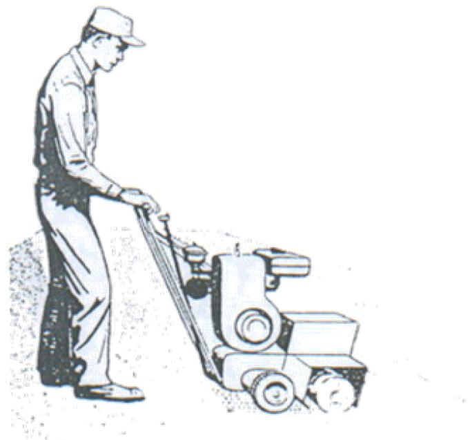
ภาพที่ 27 แสดงการบดทับด้วยเครื่องบดค้อนสันสะเทือน ที่มา : (กรมทางหลวง, 2549, หน้า 23)
