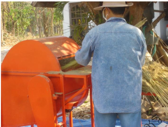
ภาพที่ 33 แสดงภาพการทดลองใช้เครื่องแยกดอกตองกง
