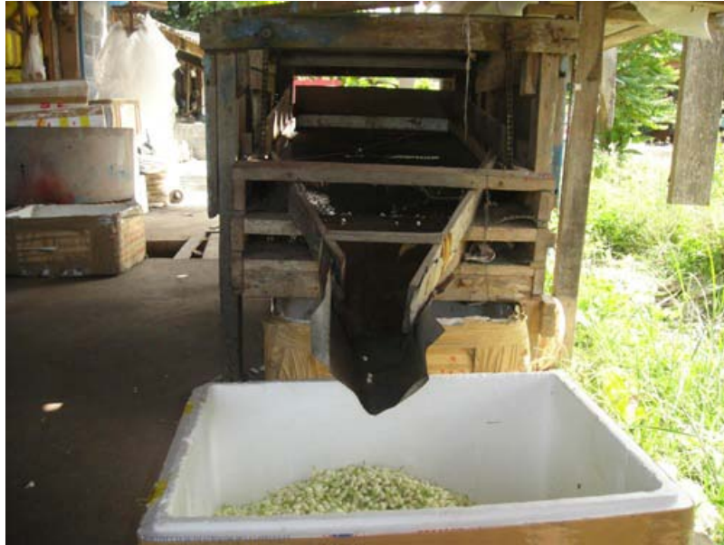
ภาพที่ 7 แสดงลักษณะเครื่องคัดแยกดอกมะลิตามภูมิปัญญาชาวบ้านบึงลาด ตำบลวังแฉม อำเภอลองขลุง จังหวัดกำแพงเพชร
