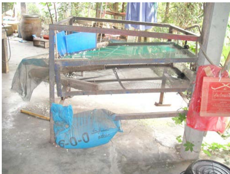
ภาพที่ 8 แสดงลักษณะเครื่องคัดแยกดอกมะลิตามภูมิปัญญาชาวบ้านหัวเสลา ตำบลป่าพุทรา อำเภอบางบาลจันทบุรี จังหวัดกำแพงเพชร
