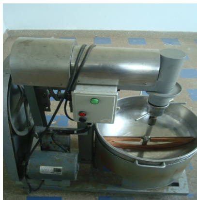
ลักษณะของเครื่องกวนผลไม้ เพื่อใช้ในอุตสาหกรรมอาหาร ที่มา (ดร.ณิ ภูคอง, 2553)
