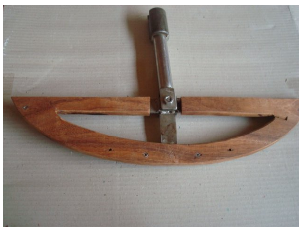
ภาพที่ 16 แสดงลักษณะของไบกวนที่ทำด้วยไม้เนื้อแข็ง ที่มา : (ครุณี ภู่ง, 2552)
