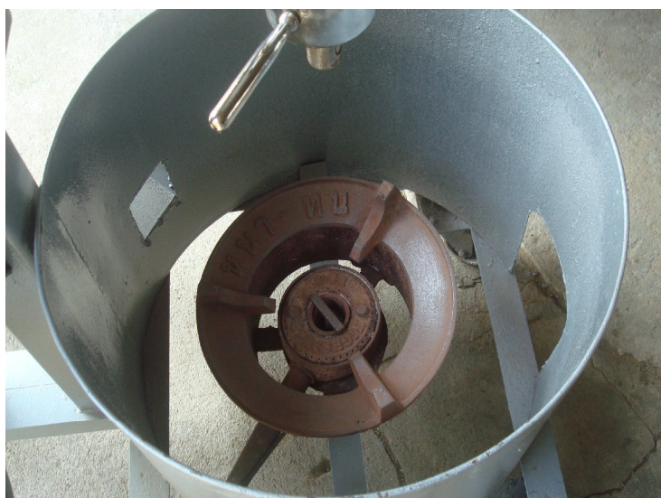
ภาพที่ 18 แสดงลักษณะของหัวเตาแก๊สสามารถปรับเปลี่ยนและถอดออกได้ ที่มา (ครุณี ภู่ง, 2552)
