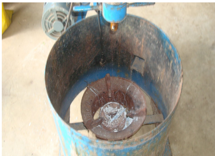
ภาพที่ 17 แสดงลักษณะของหัวเตาแก๊สที่เชื่อมติดกับฐาน โครงสร้างเครื่องกวนผลไม้ ที่มา : (ครุณี ภู่ง, 2552)
