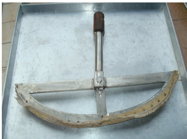
ภาพที่ 15 แสดงลักษณะของไบกวนที่ทำด้วยผ้าใบ ที่มา : (ครุณี ภู่ง, 2552)
