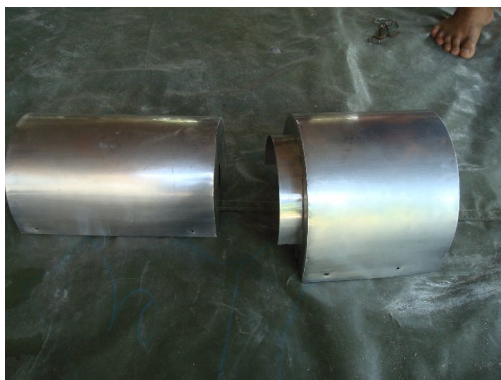
ภาพที่ 13 แสดงลักษณะของฝาครอบโซ่และแกนเพลลา
