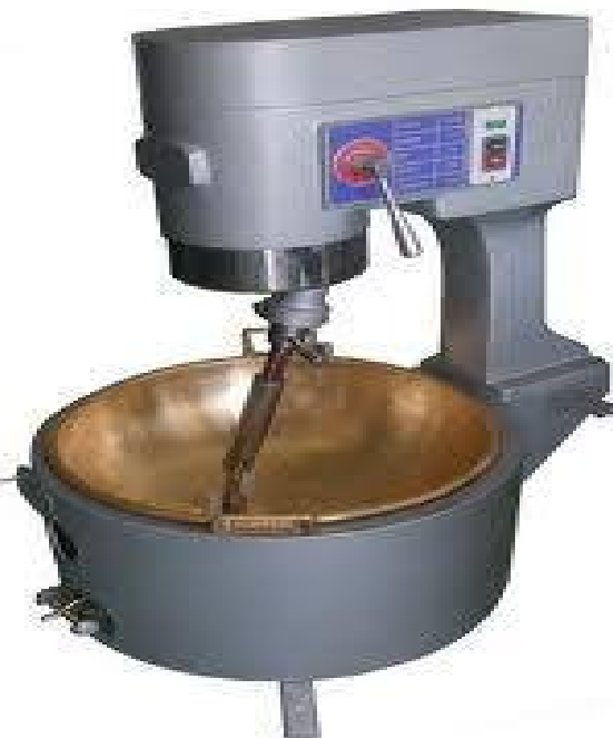
ภาพที่ 6 เครื่องกวนมะม่วงอัตโนมัติ ที่มา : (วัชรินทร์ สิงห์บุตร และจิรภัทร ทับพันธุ์ , 2552)
