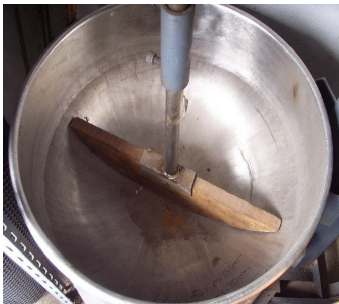
ภาพที่ 7 เครื่องกวนสับประรด ที่มา : (จักรพันธ์ ปิ่นทอง, 2553)
