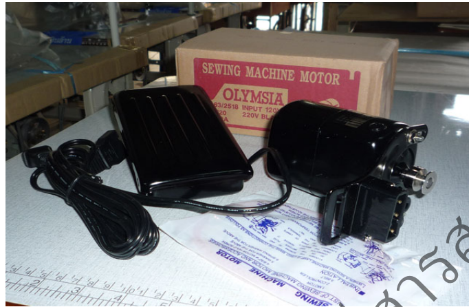
ภาพที่ 21 แสดงลักษณะมอเตอร์ ขนาด 90 วัตต์
