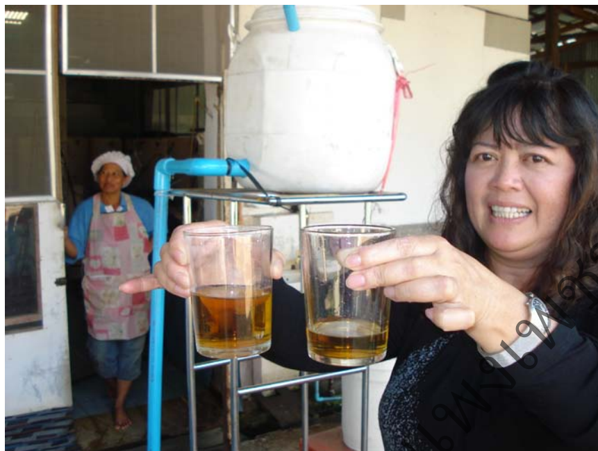
ภาพที่ 40 แสดงการเปรียบเทียบความใสของน้ำปลาที่กรองแบบดั้งเดิมของชาวบ้านกับการกรองด้วยเครื่องกรองที่พัฒนาขึ้นมาใหม่ ได้ความใสเช่นเดียวกัน
