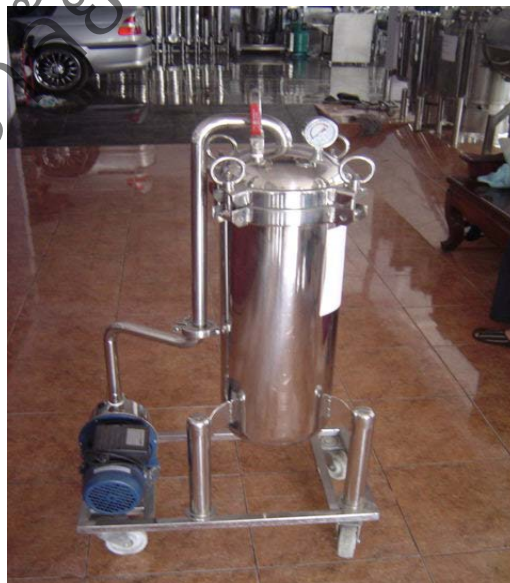
ภาพที่ 14 แสดงลักษณะเครื่องกรองถุงผ้า
