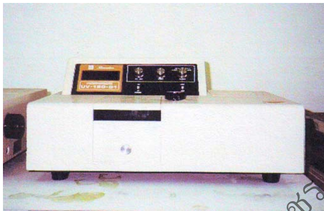
ภาพที่ 37 เครื่อง Spectrophotometer ใช้ในการวิเคราะห์ปริมาณฟอสฟอรัสและโพแทสเซียม
