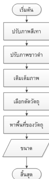
ภาพที่ 3.2 ขั้นตอนการทำงานของซอฟต์แวร์ส่วนของการประมวลผลภาพบนคอมพิวเตอร์
