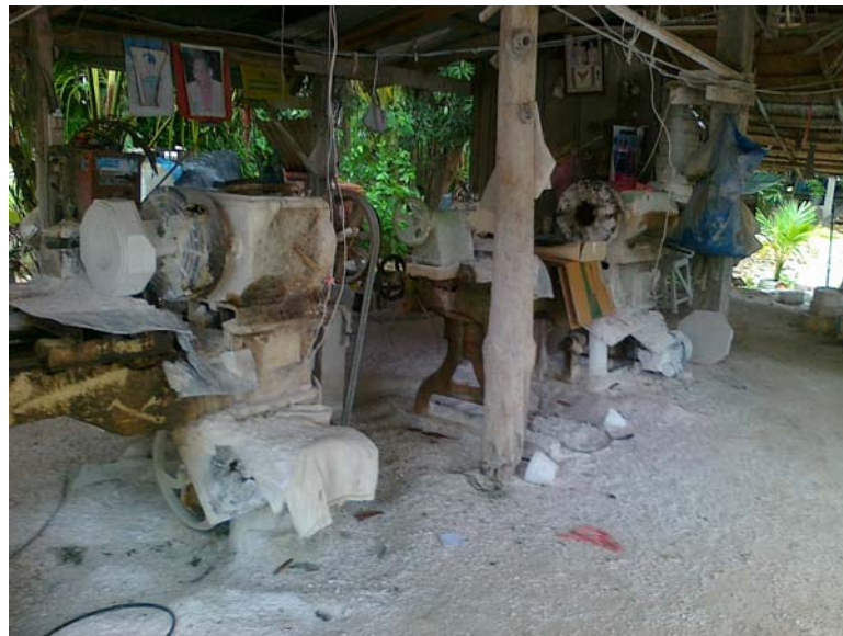
ภาพแท่นขัด ใช้ขัดผิวของผลิตภัณฑ์ที่เจียรเป็นรูปร่างแล้ว เพื่อความเรียบและเงางามของผลิตภัณฑ์
