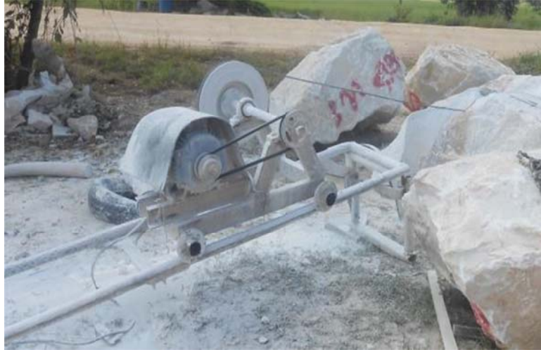
ภาพที่ 4.2 การตัดหินอ่อนด้วยเครื่องจักรที่เป็นโซ่กากเพชร
