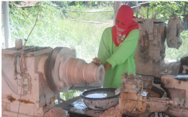
ภาพที่ 4.5 การเหลาและกลึงหินอ่อนด้วยเครื่องกลึง
