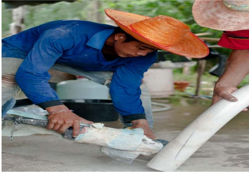
ภาพที่ 4.6 การขัดมันหินอ่อนด้วยเครื่องจักร และกระดาษทราย
